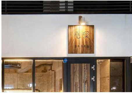
间接照明 (投光灯)
