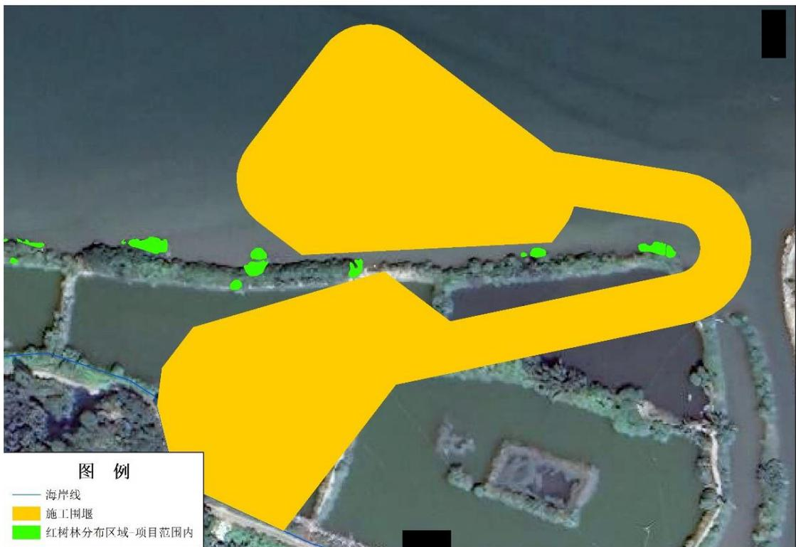
图 4.2-6 临时施工围堰（南侧）与现状红树林的位置关系
