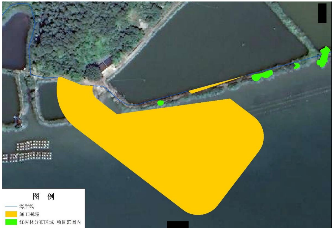
图 4.2-5 临时施工围堰（北侧）与现状红树林的位置关系
