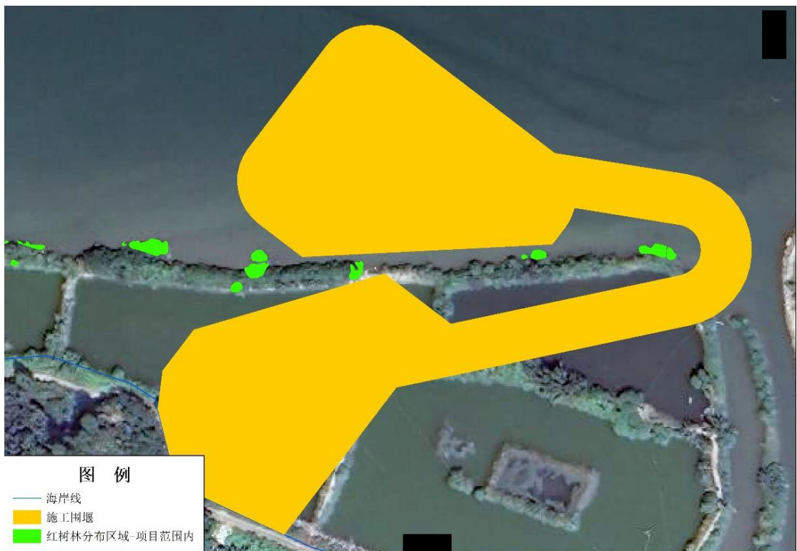
图 4.2-6 临时施工围堰（南侧）与现状红树林的位置关系
